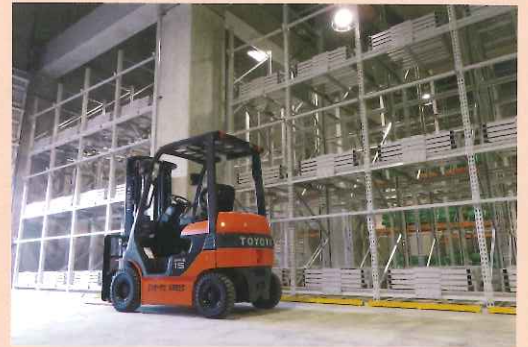
救援物資備蓄スペースに設置された傾斜式流動棚
